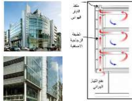
شكل 18. يوضح نظام الاستخلاص الهوائي (Extract Air)
