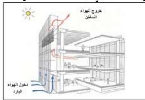
شكل 9. يوضح شكل نموذجي لواجهة الغلاف
