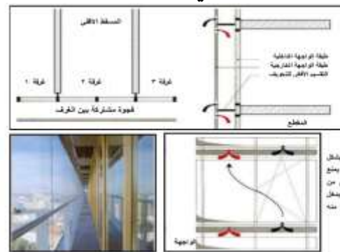
شكل 13. يوضح واجهة ممر الهواء (المسقط الافقي، المقطع
