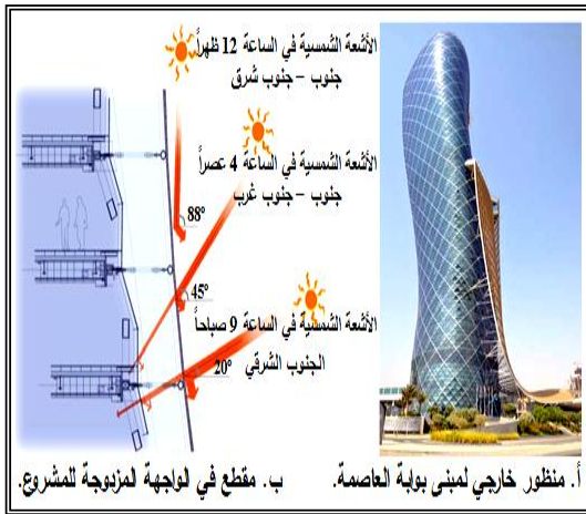
شكل 1: الواجهة مزدوجة القشرة في مبنى "بوابة العاصمة (Capital Gate)" الواقع في إمارة أبو ظبي - الإمارات
