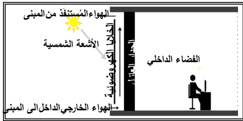
شكل 4: مقطع في واجهة مزدوجة تضم خلايا كهروضوئية
