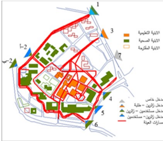
شكل رقم (4) محاور الدخول ومسارات الحركة في مستشفى مدينة الطب (الباحث باستخدام برنامج الاوتوكاد)
