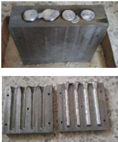
الشكل 2: القالب الفولاذي المستخدم للصب
