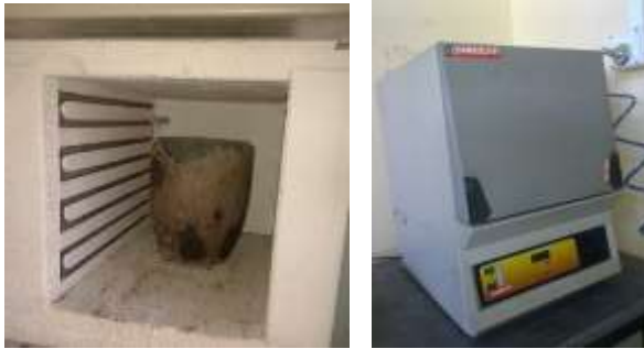
الشكل 1: الفرن الكهربائي المستخدم في الصهر وبداخله البوتقة
