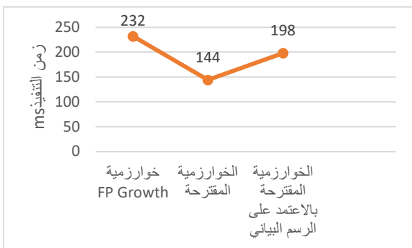
الشكل 10: مقارنة بين خوارزمية FP Growth والخوارزمية المقترحة والخوارزمية المعتمدة على المخطط من حيث زمن التنفيذ
