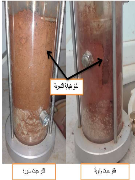
الشكل 9 : النموذج في نهاية التجربة عند استخدام مرشح بحص
