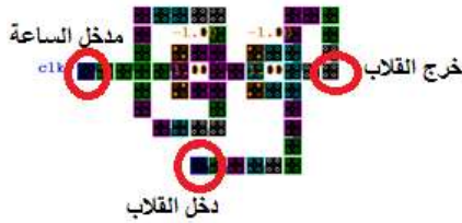
الشكل 13: بنية القلاب المستخدم بعد تعديل موقع مدخل الساعة
