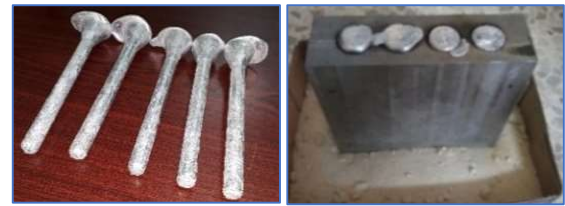
الشكل 10: القالب والعينات بعد الصب
