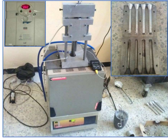
الشكل 9: آلة السبائك بالمزج التي تم تصنيعها
