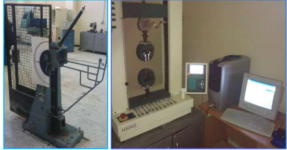
الشكل 13: أجهزة الفحص والاختبارات: المجهر الإلكتروني نوع FEI طراز Quanta 200 - جهاز حيود الأشعة السينية نوع Philips طراز PW 1830 - جهاز الشد نوع (Tenius Olsen- H50KS) - جهاز الصدم نوع (BROOKS)
