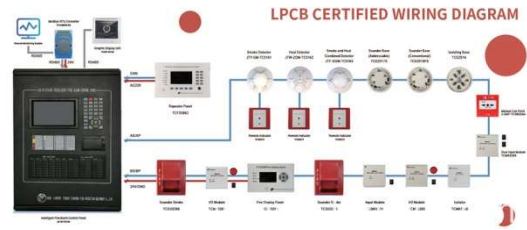
الشكل 15: يبين عمل لوحة تحكم إنذار الحريق JB-TB-TC5120
