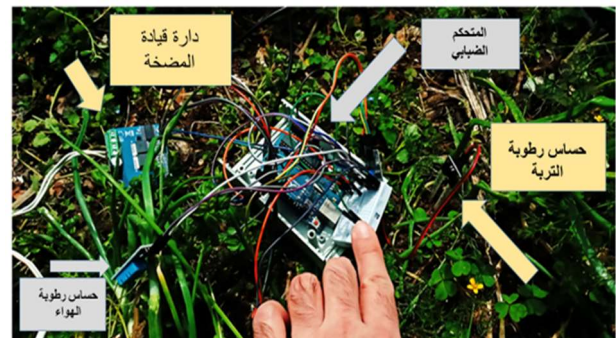
الشكل 13: المتحكم الضبابي مع الحساسات ودائرة قيادة المضخة.
