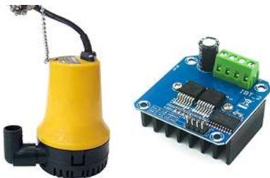
الشكل 10: مضخة المياه المستخدمة ودائرة القيادة.
