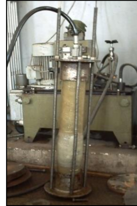
الشكل رقم (8): يبين اختبار الضغط الداخلي لأنبوب GRP الأول بعد الإصلاح.
