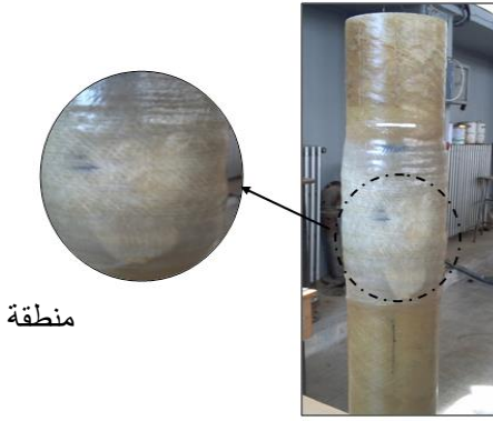
الشكل رقم (9): يبين مؤشرات انهيار ضمام الإصلاح لأنبوب GRP الأول.
