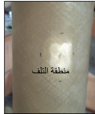
الشكل رقم (2): منطقة التلف بالصدمة للأنبوب GRP الأول.
