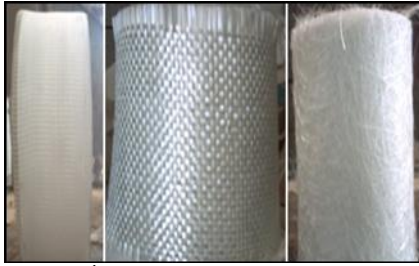
الشكل رقم (5): يظهر المات والألياف المنسوجة ونسيج البوليستر على الترتيب و المستخدمة في الإصلاح.
