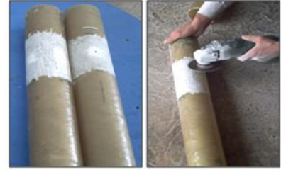
الشكل رقم (4): يبين طريقة تحضير منطقة الإصلاح لعينتي الأنبوب GRP.
