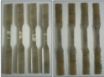
الشكل رقم (10): يبين عينات الشد الطولي من الخارج والداخل على الترتيب.
