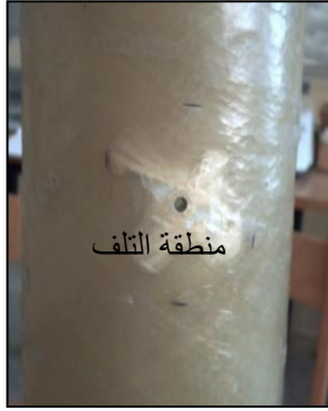
الشكل رقم (3): منطقة التلف بالصدمة للأنبوب GRP الثاني مع الثقب.
